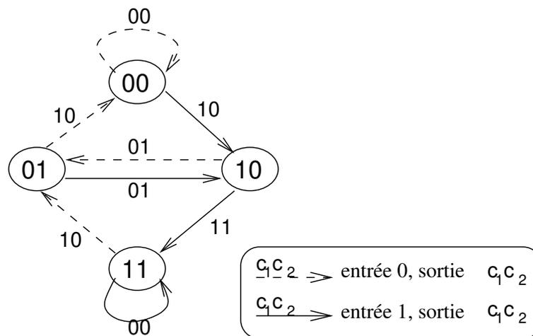
FIGURE 1 – Diagramme d'états d'un codeur convolutif  $C(2, 1, 3)$  (entrée 1 bit, sortie 2 bits).
