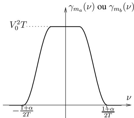
FIGURE 3 – DSP d'un signal NRZ durée symbole  $T$  avec des impulsions en cosinus surélevé.
