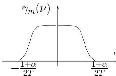
FIGURE 3 – Densité spectrale de puissance d’un signal de communication NRZ M-aire à impulsions en cosinus surélevé de facteur de retombée  $\alpha$ .
